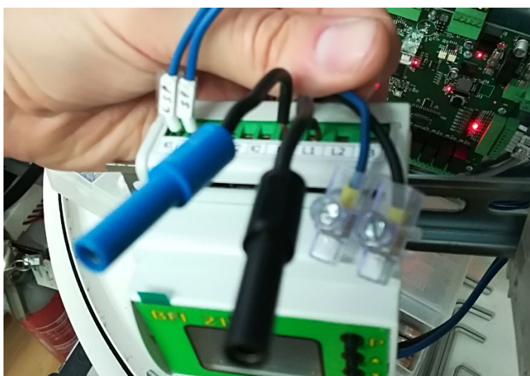
Figura 37 - Dettaglio morsetti inserimento tensioni di rottura in interfaccia
