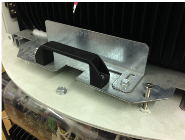
Figura 22 - Fissaggio batteria a struttura
