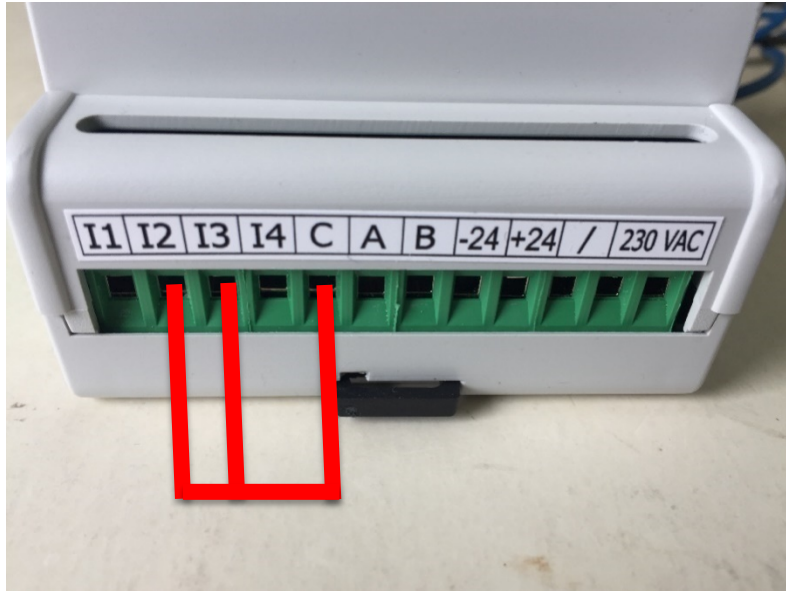
Figura 34 - Ponticelli da inserire nel caso di soglie restrittive
