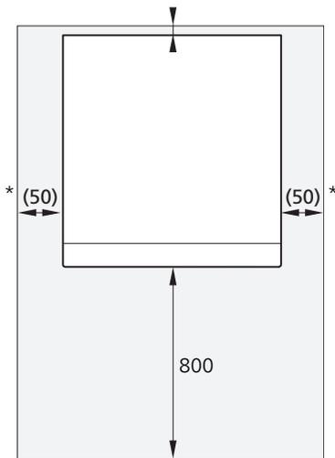
\* Una normale installazione richiede 300 – 400 mm (su qualsiasi lato) per il collegamento delle apparecchiature, quali il vaso di livello, le valvole e le apparecchiature elettriche.
