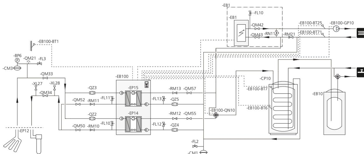
La pompa di calore (EB100) assegna la priorità alla produzione di acqua calda con metà della potenza (modulo frigorifero EP14) tramite una valvola deviatrice (EB100-QN10). Quando il bollitore / serbatoio di accumulo (CP10) è pieno (EB100-QN10), essa commuta al circuito di riscaldamento.
