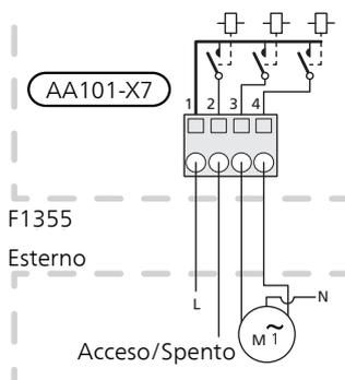
È possibile bloccare completamente il riscaldamento supplementare collegando un contatto privo di potenziale alla morsettiera di ingresso AUX AA3-X6 e AA101-X10. La funzione deve essere attivata nel menu 5.4.
